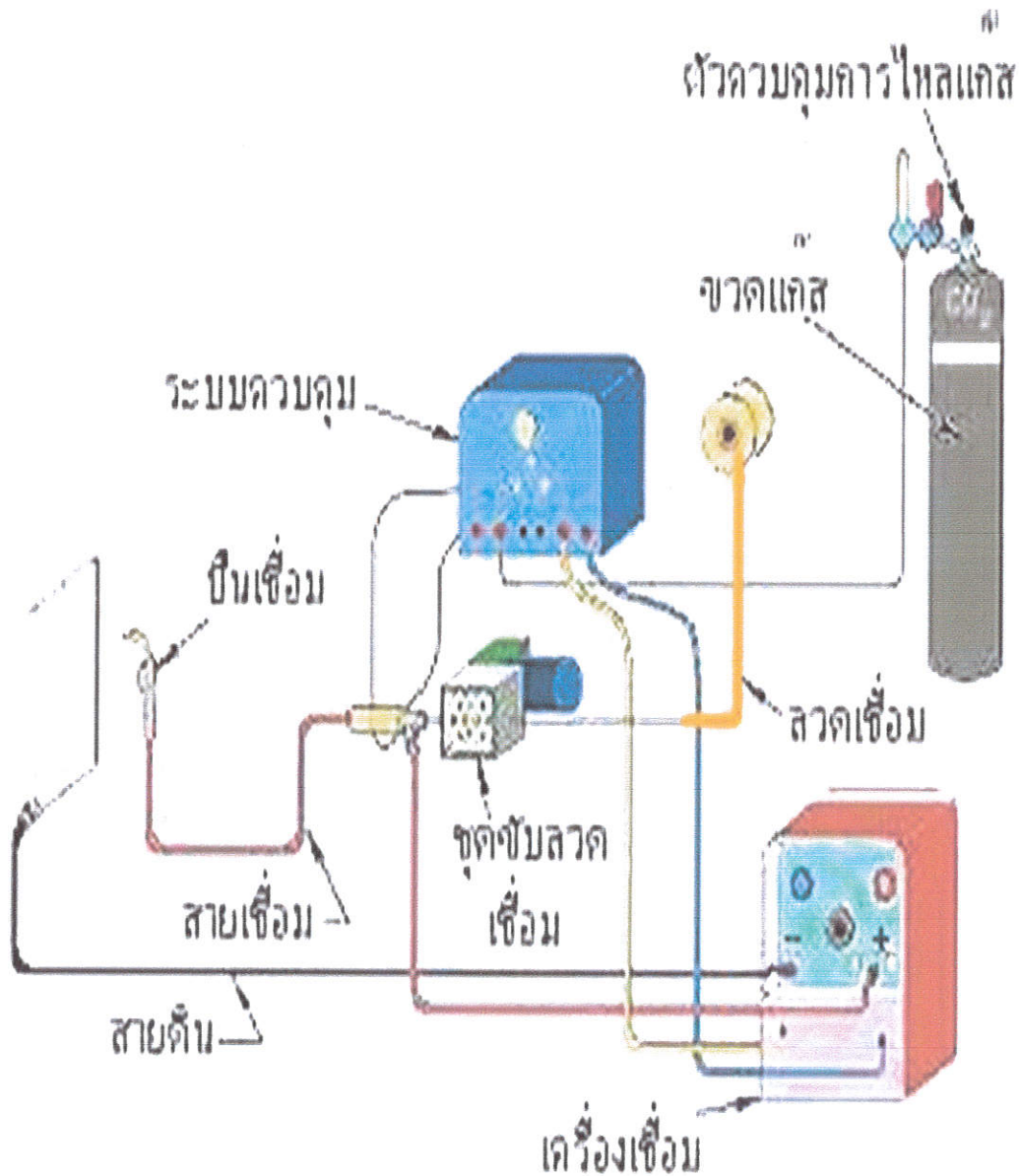
วงจรในระบบการเชื่อม MIG/MAG
